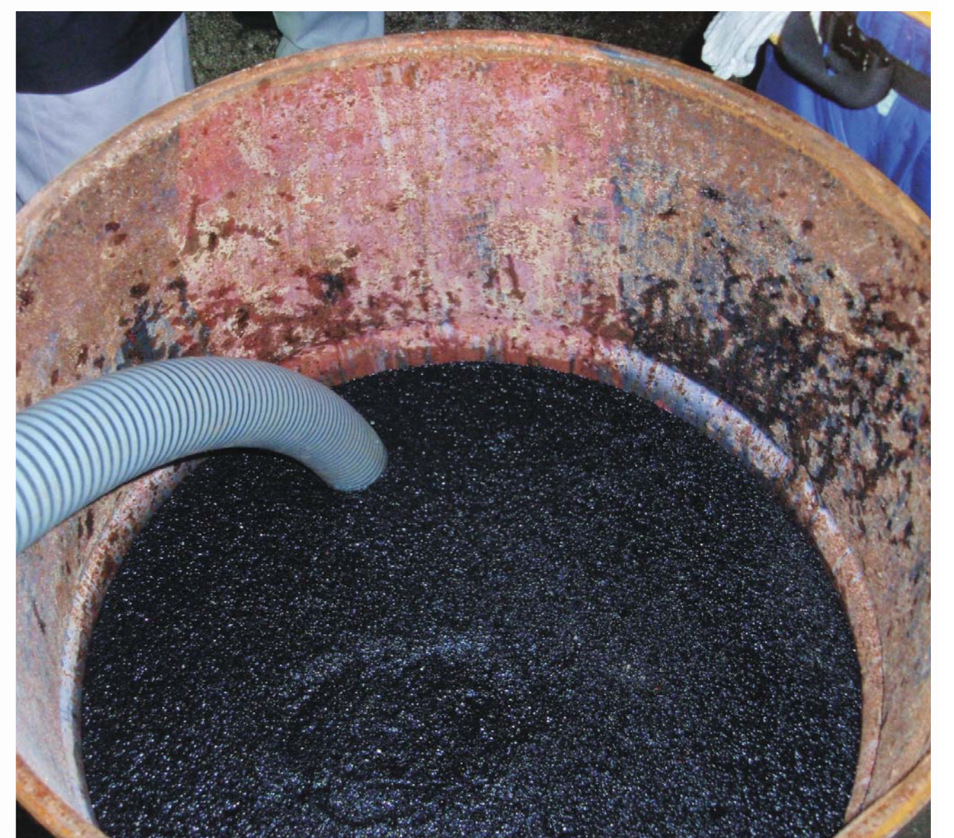
汚泥圧送管より回収された夾雑物
