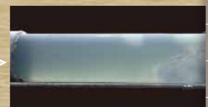
④夾雑物が除去された管内の状況
