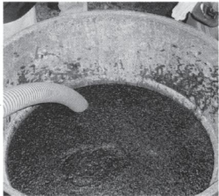
汚泥圧送管より回収された夾雑物
